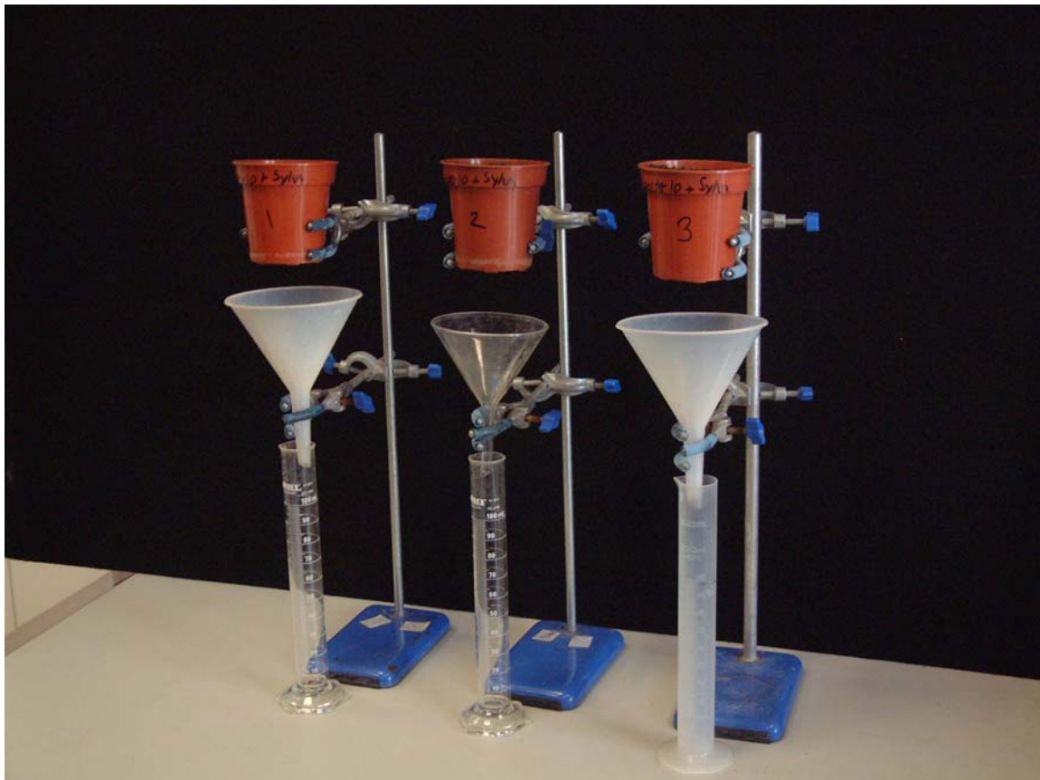
Photo 2 Pour-through test apparatus
